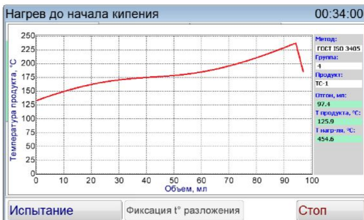
Рисунок 19 – Просмотр кривой разгонки
