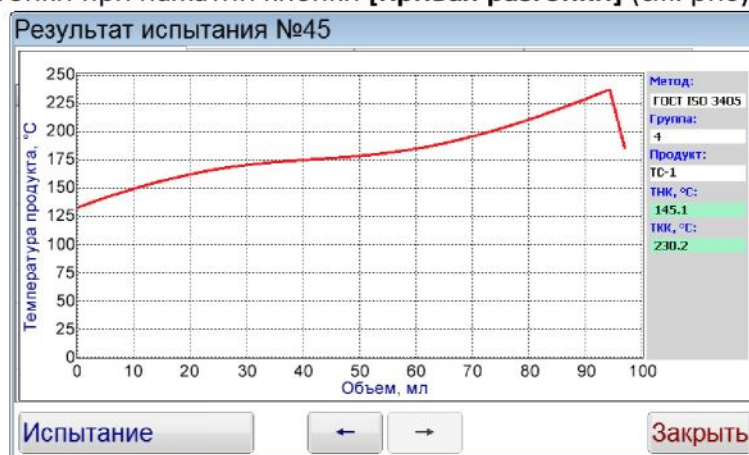
Рисунок 24 – Просмотр кривой разгонки
