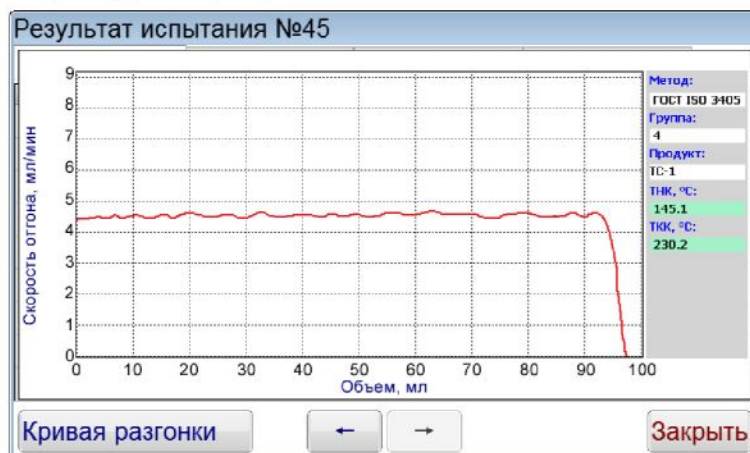
Рисунок 23 – График скорости отгона
