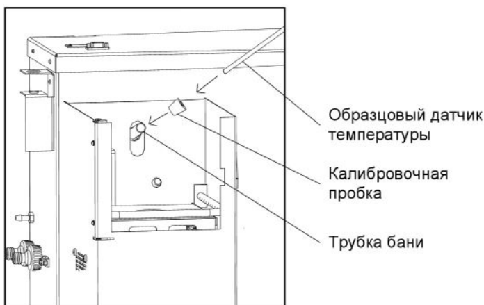
Рисунок 35 – Подготовка к проверке датчика температуры бани
