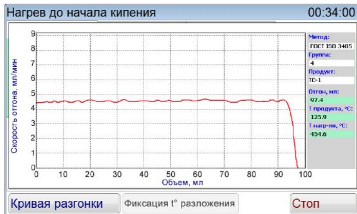
Рисунок 18 – График скорости отгона
