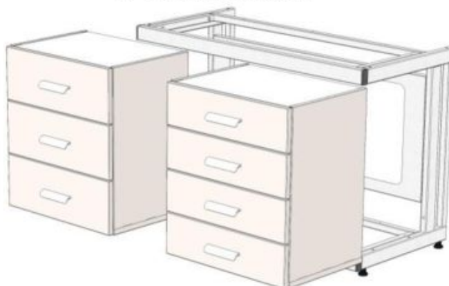
Рис. 1. Установка высоких тумб на каркас
