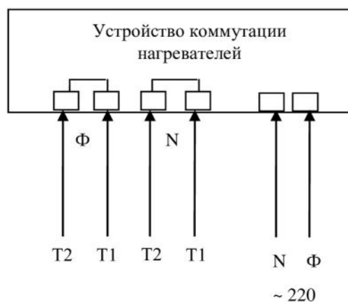
Рис. 2. Схема подключения пульта управления.
