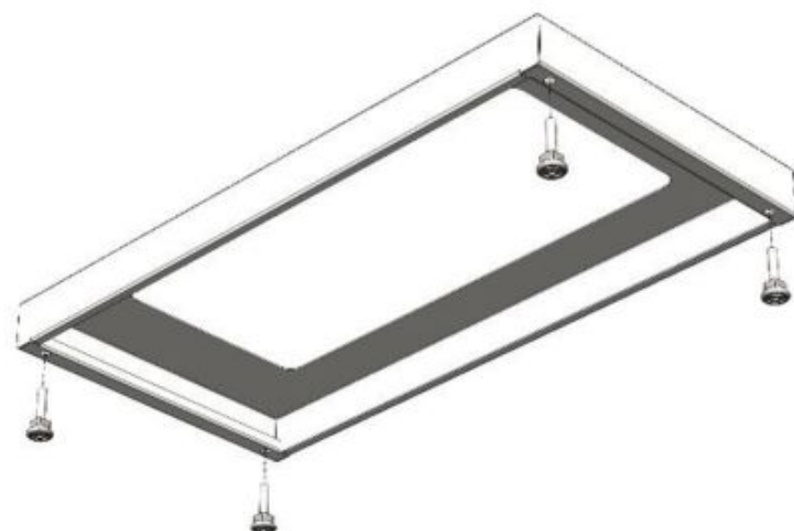
Рис. 2. Сборка низкого каркаса
