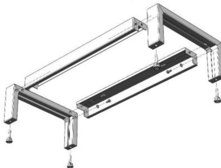
Рис. 1. Сборка высокого каркаса
