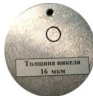
Натурная мера толщины металлического покрытия на образцовом основании (электролитический никель толщиной h_{\text{макс}} = 16 мкм)
