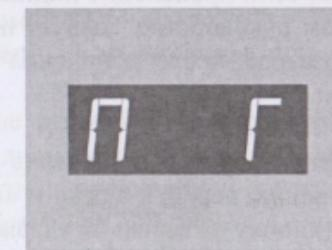
Рисунок 2.12 – Анализатор находится в режиме подкалибровки.
