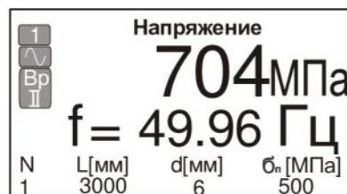
Рисунок 20. Режим определения предварительного напряжения и частоты колебания арматуры. Измерение выполнено.
