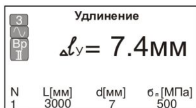
Рисунок 34. Режим №3, определение заданного удлинения арматуры.
