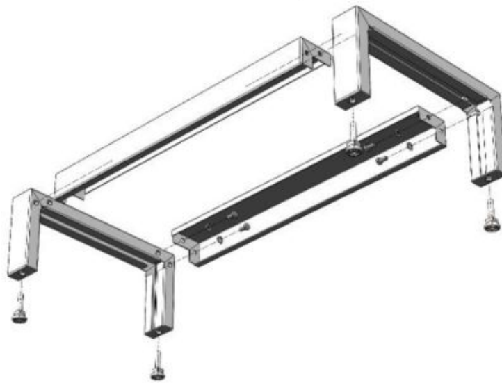
Рис. 1. Сборка высокого каркаса
