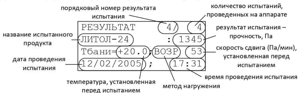
Рисунок 37 - Результат испытания. Информация на дисплее
