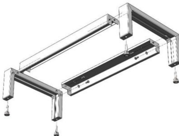
Рис. 1. Сборка высокого каркаса
