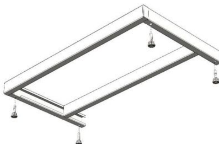
Рис. 2. Сборка низкого каркаса
