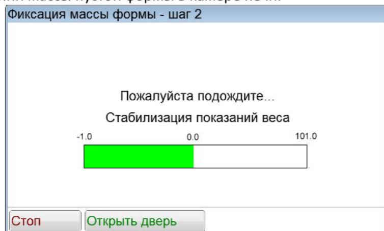
Рисунок 9 – Стабилизация показаний веса (значения указаны произвольно)
