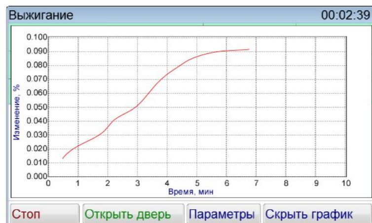
Рисунок 15 – График изменения массы в процессе выжигания
