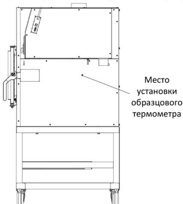
Рисунок 40 – Место установки образцового термометра (вид печи сбоку)
