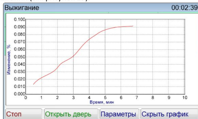
Рисунок 29 – График изменения массы в процессе выжигания
