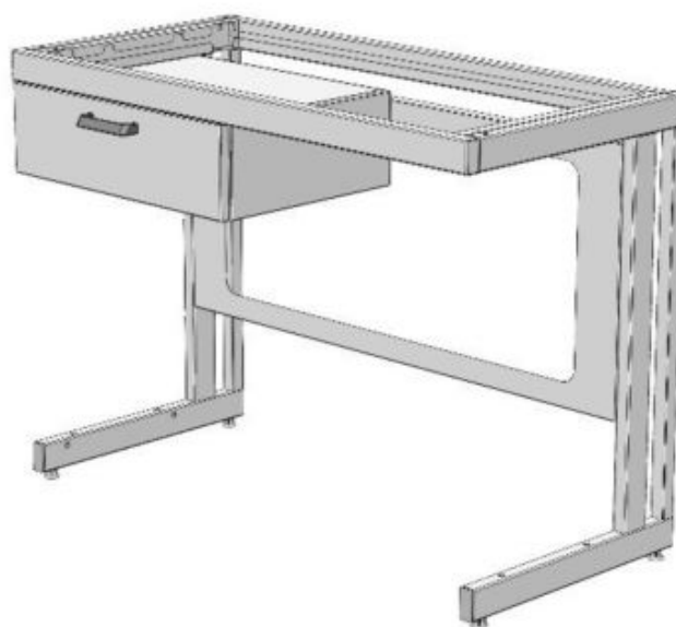
Рис. 2. Установка ящика в корпус
