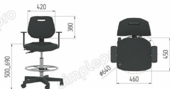
СТУЛ ЛАБОРАТОРНЫЙ СХЕМА|СХЕМА ESD
