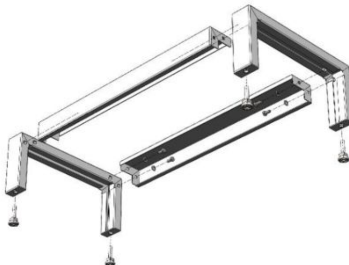
Рис. 1. Сборка высокого каркаса
