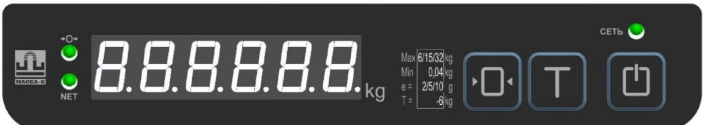
Рисунок 2 – Лицевая панель устройства управления. Клавиатура
