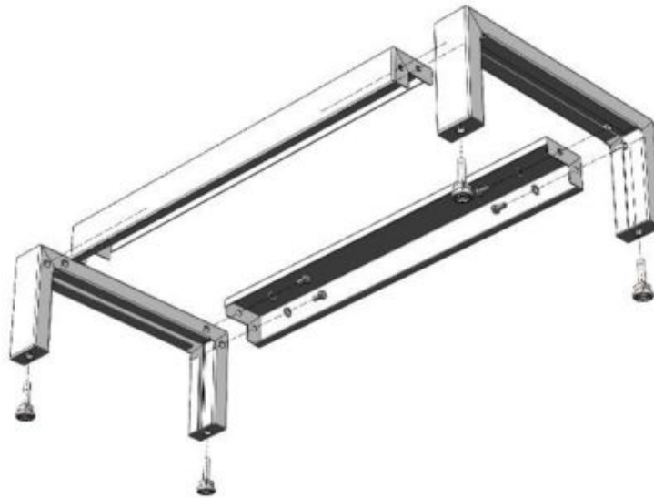
Рис. 1. Сборка высокого каркаса
