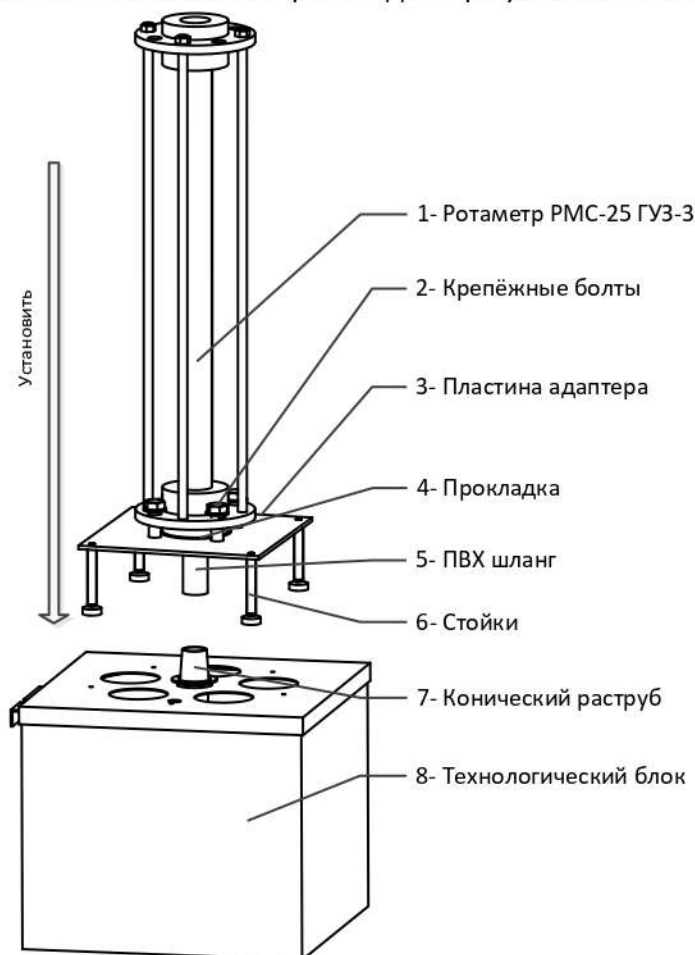
Рисунок 16 – Установка измерителя расхода
