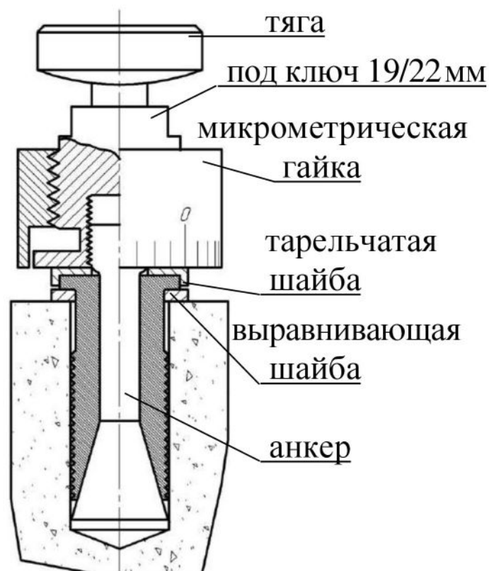
Рисунок 2.3.б – Установка анкера для остальных модификаций
