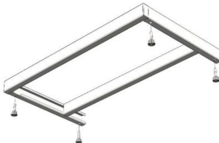
Рис. 2. Сборка низкого каркаса
