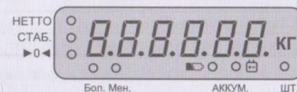
Рисунок 4.2 – Вид дисплея со всеми включенными сегментами и указатели
