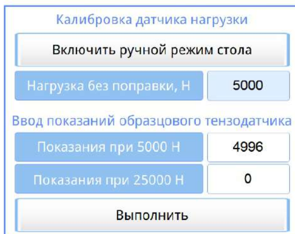
Рисунок 15 - Проверка тензодатчика в точке 5000Н
