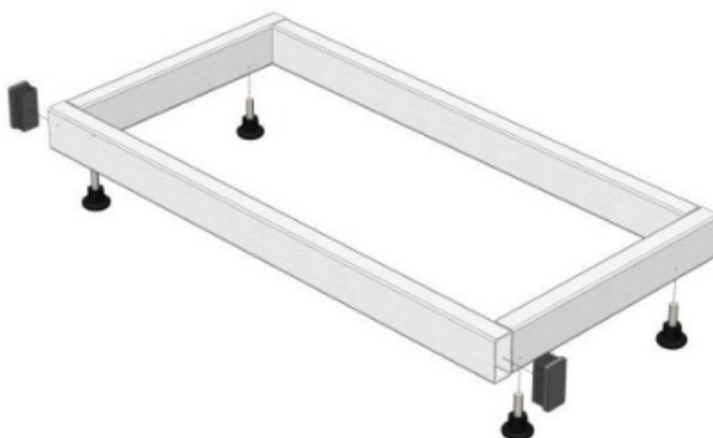
Рис. 2. Сборка низкого каркаса
