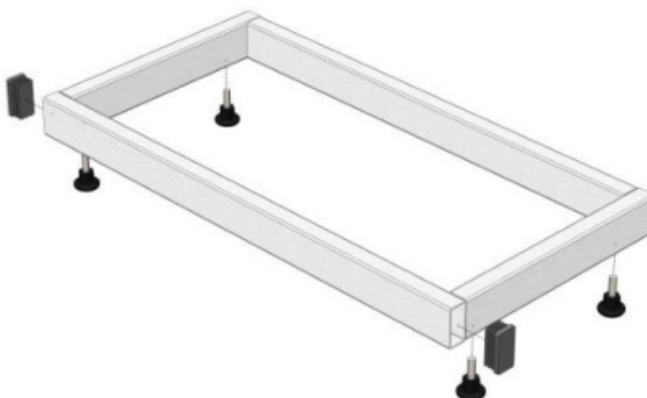
Рис. 2. Сборка низкого каркаса
