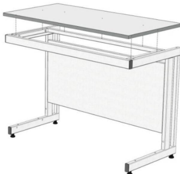
*Рис. 1. Установка рабочей поверхности*
