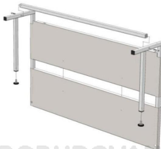
Рис. 2. Сборка каркаса надстройки
