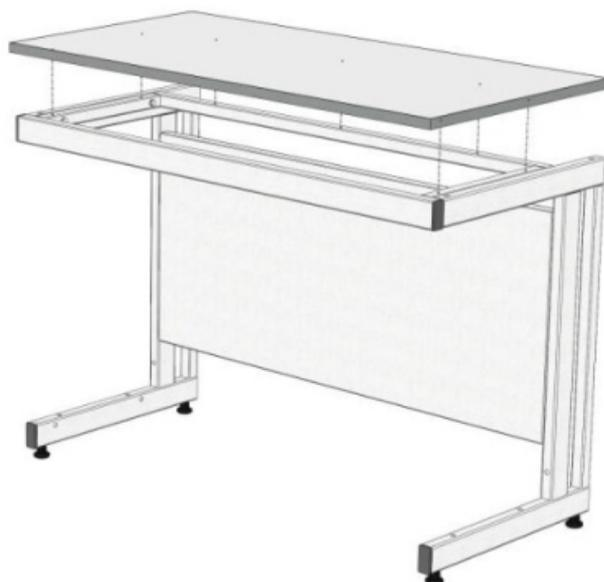
*Рис. 1. Установка рабочей поверхности*
