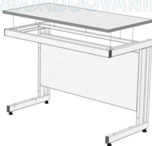
Рис. 1. Установка рабочей поверхности
