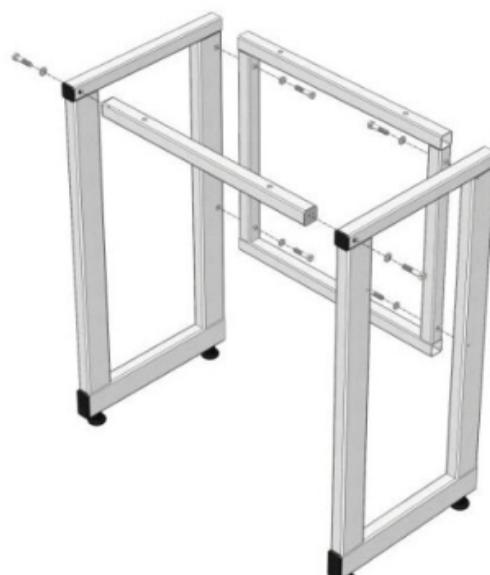
Рис. 2. Сборка каркаса стола СВ
