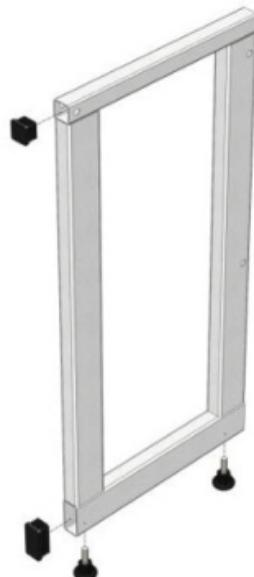
Рис. 1. Сборка боковины каркаса
