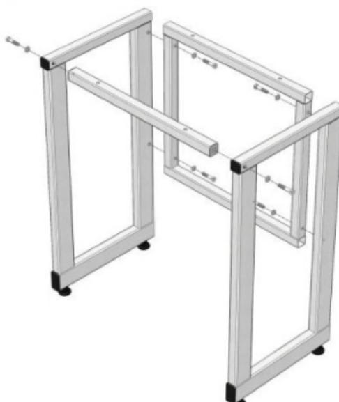
Рис. 2. Сборка каркаса стола
