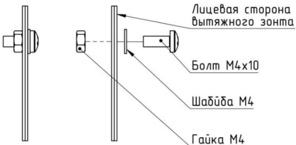
Рис. 1. Схема установки крепежа
