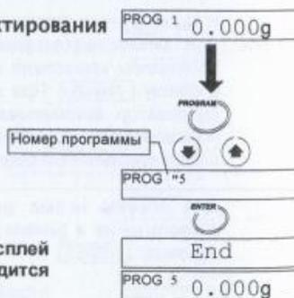
**Предупреждение** При активной функции памяти, на дисплей вместо номера программы (PROG) выводится номер данных в памяти (MEM).
