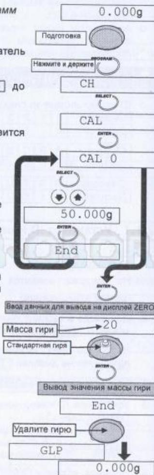
10. Снимите гирю для возвращения в режим взвешивания. При необходимости вывода отчета в формате GLP, GMP или ISO (См."13. Таблица функций"), на дисплее появляется индикация **GLP**. Условия вывода отчета устанавливаются в таблице функций.
