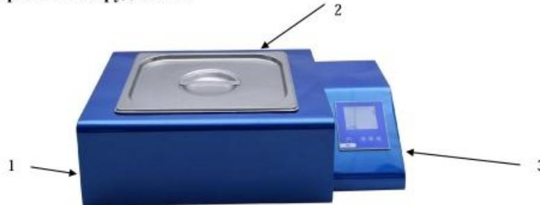
Прибор (см. рис. 1) состоит из металлического корпуса (1), рабочей емкости с крышкой (2) и блока управления температурой нагрева (3).
