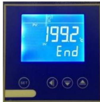
После окончания времени работы прибор прекратит нагрев и в течении 1 минуты будет издавать короткие звуковые сигналы интервалом в несколько секунд. В разделе дисплея «PV» будет отражаться остаточная температура на нагревательной поверхности, а в разделе дисплея «SV» будет гореть надпись «End». Для начала нового цикла нагрева нужно выключить и включить прибор заново при помощи кнопки включения/выключения.
