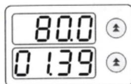
**Цифровой светодиодный дисплей** – во время работы отображает текущую температуру теплоносителя в бане. Переключается на отображение текущего времени таймера с помощью нажатия кнопки «увеличить/отобразить».
