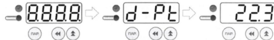
**Рисунок 3 - Последовательность показаний дисплея при запуске**
