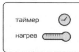
**Таймер** – лампа мигает или горит, если включен обратный таймер.
