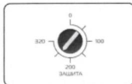
**Защитный термостат** – предотвращает превышение рабочей температуры. Рекомендуется устанавливать значение температуры защиты на 10-20% выше значения рабочей температуры. При срабатывании отключает питание нагревательного элемента, предотвращая перегрев.
