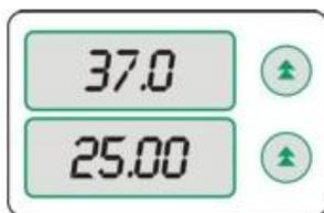
**Цифровой светодиодный дисплей** – во время работы отображает текущую температуру теплоносителя в бане. Переключается на отображение текущего времени таймера с помощью нажатия кнопки «увеличить/отобразить».
