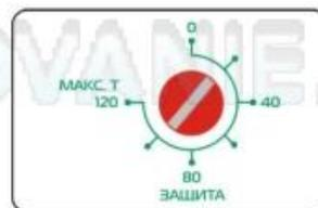
**Защитный термостат** – предотвращает превышение рабочей температуры. Рекомендуется устанавливать значение температуры защиты на 10-20% выше значения рабочей температуры. При срабатывании отключает питание нагревательного элемента, предотвращая перегрев.
