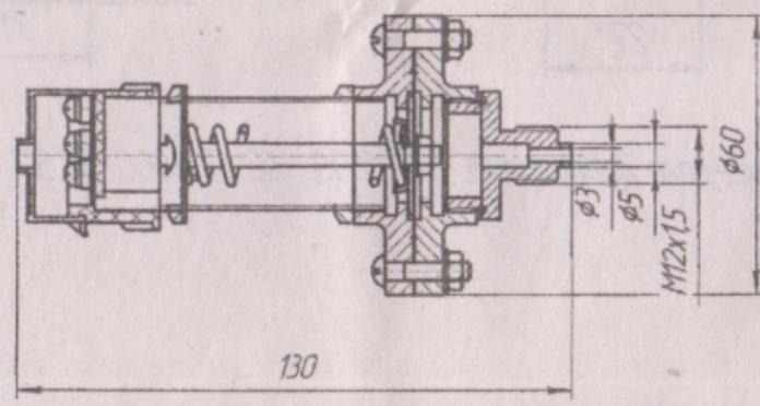
Датчик-реле напора ДЕ 57-40
