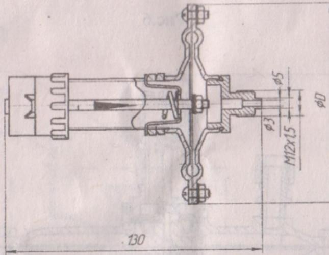
Датчик-реле напора ДЕ 57-6I. ДЕ 57-25T
