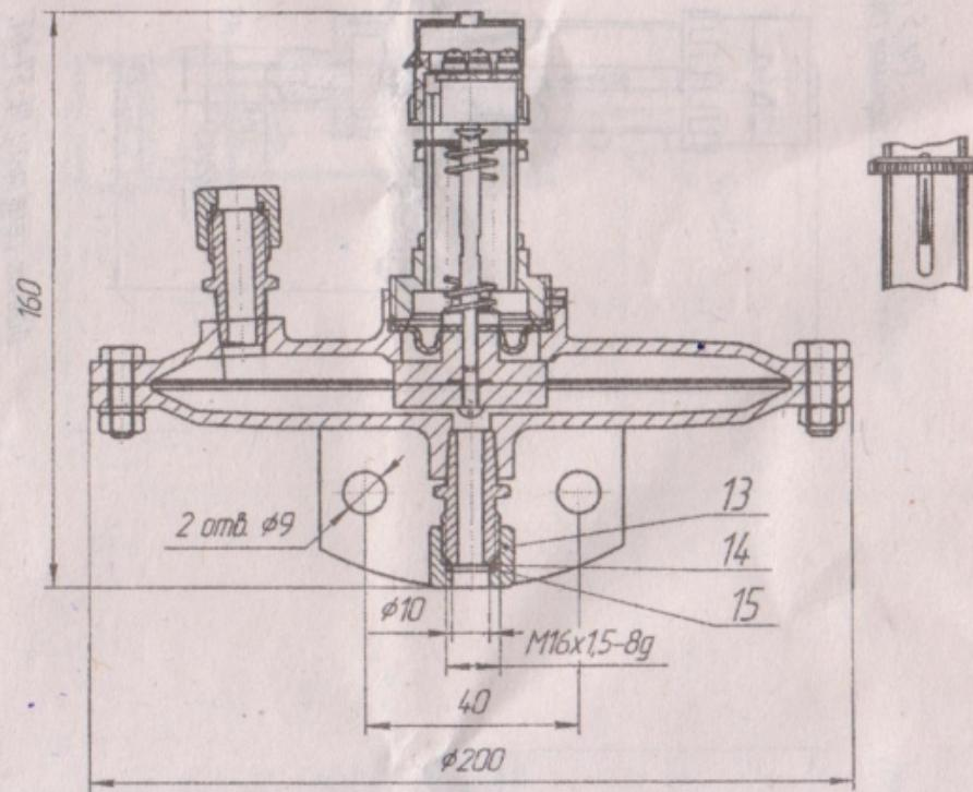
Датчик-реле перепада напора ДЕ 57-2,5ПН
