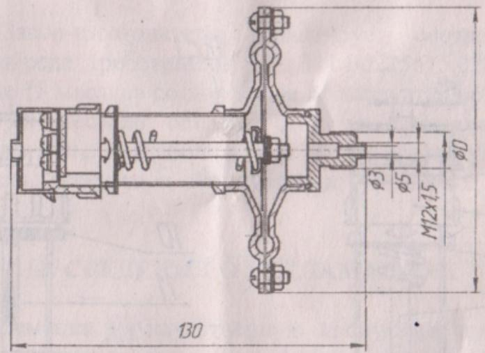
Датчик-реле напора ДЕ 57-6. ДЕ 57-25
