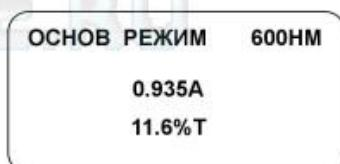
Рисунок 9. Однократное измерение оптической плотности и процента пропускания раствора.
