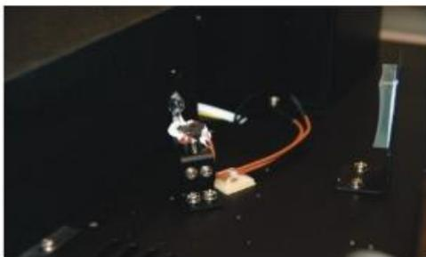
Рисунок 23 - Крепление галогенной лампы.
