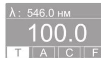
Рисунок 5 - Режим измерения пропускания.
