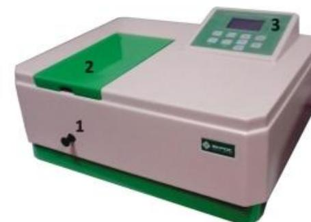
Рисунок 3 - Спектрофотометр ПЭ-5400УФ.
