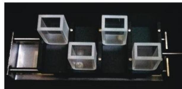
Рисунок 2 - Установка кювет в шахматном порядке.
