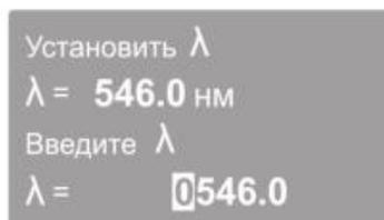
Рисунок 8 - Установка длины волны.
