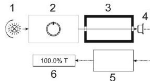
Рисунок 1 - Функциональная схема спектрофотометра.
