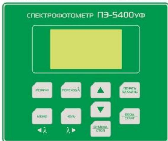
Рисунок 4 - Панель управления спектрофотометра ПЭ-5400УФ.
