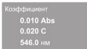
Рисунок 18 - Измерение с расчётом концентрации по коэффициентам.
