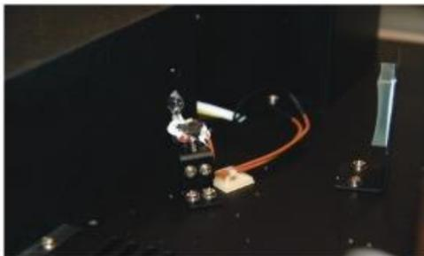
Рисунок 23 - Крепление галогенной лампы.
