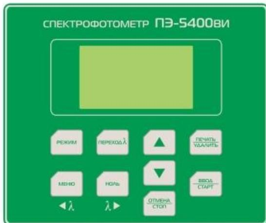
Рисунок 4 - Панель управления спектрофотометра ПЭ-5400ВИ.
