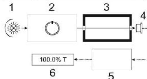
Рисунок 1 - Функциональная схема спектрофотометра.
