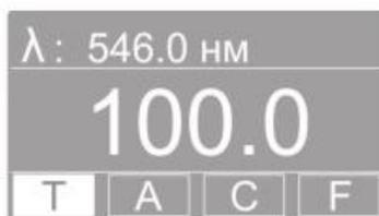
Рисунок 5 - Режим измерения пропускания.
