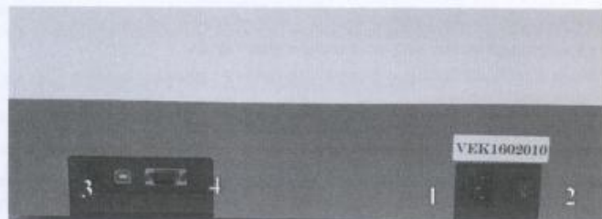
Обозначения: 1 - Гнездо для подключения сетевого шнура; 2 - Сетевой выключатель; 3 - Разъем для подключения к ПК; 4 — Разъемы для подключения принтера.
