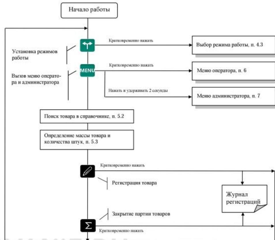
Табл. 3.3 - Схема работы терминала
