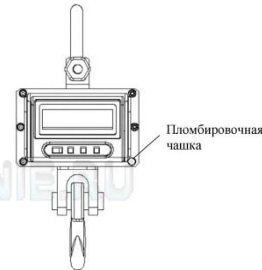
Рис. 16.1 - Место нанесения оттиска поверительного клейма
