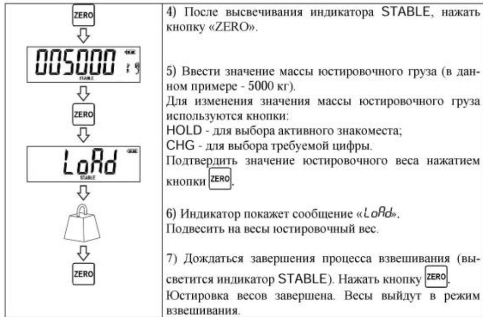
При каждой юстировке в память весов записывается контрольное число (код юстировки), которое изменяется автоматически после каждой юстировки.
