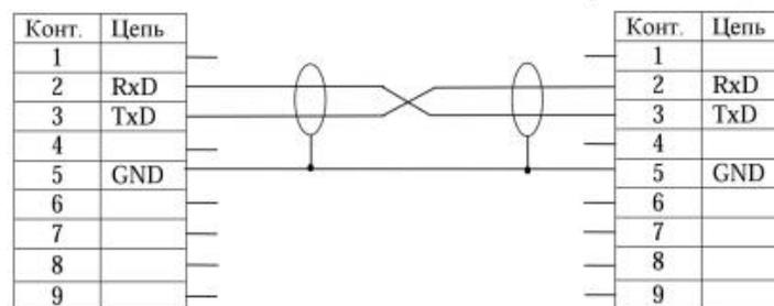
Рис. 9.2 - Кабель, для подключения весов с вилкой DB-9M
