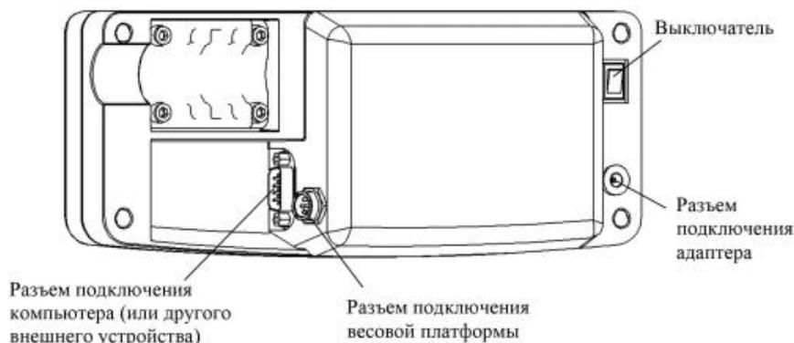
Рис. 5.3 - Устройство индикации
