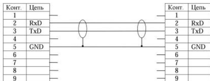
Рис. 9.3 - Кабель, для подключения весов с розеткой DB-9F
