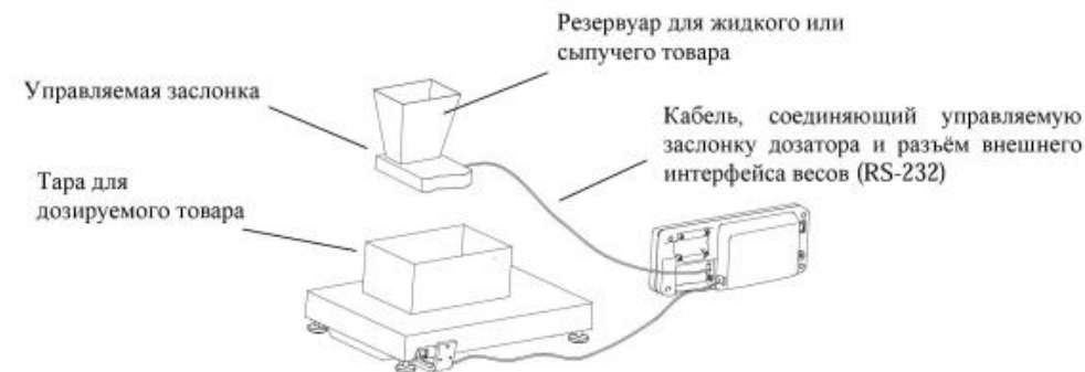
Рис. 7.2 - Подключение весов к дозирующему устройству
