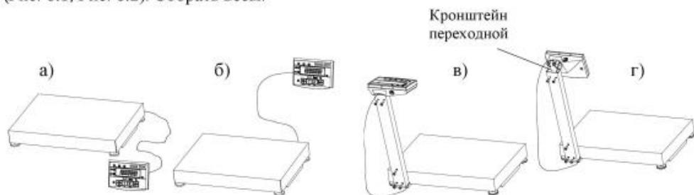
Рис. 6.1 - Варианты размещения устройства управления:
