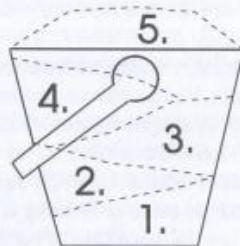
2. Плотно вставьте зонд в фураж, чтобы он имел полный контакт с образцом. Зонд не должен касаться ведра.
