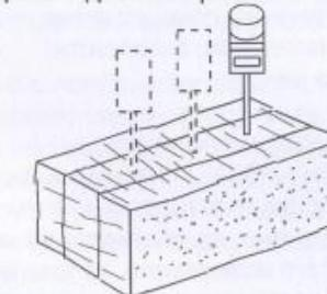
В круглых тюках измерение влажности производится в нескольких точках вокруг тюка.
