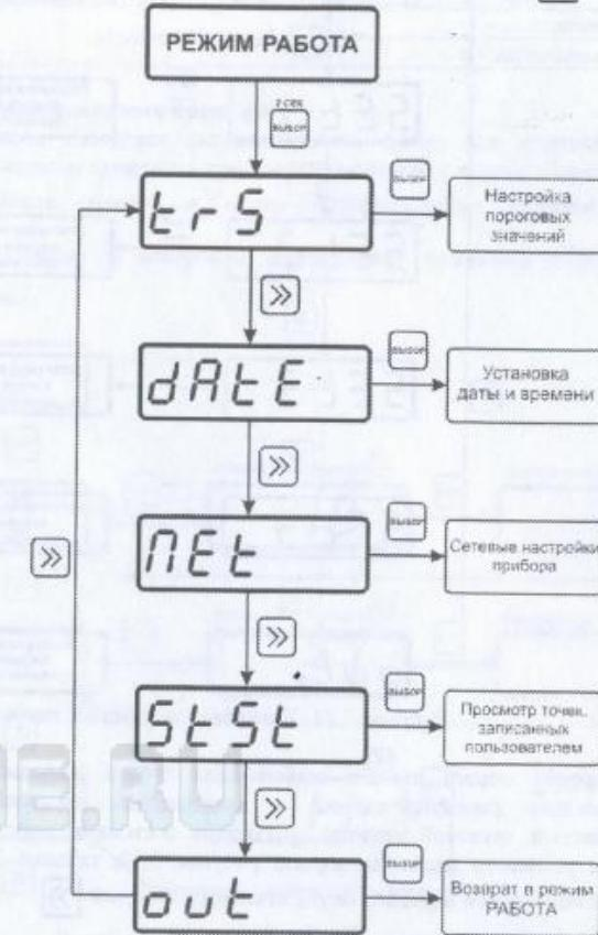
Рисунок 5.10 Схема режима НАСТРОЙКА ИВТМ-7 М 1, ИВТМ-7 М 2,
