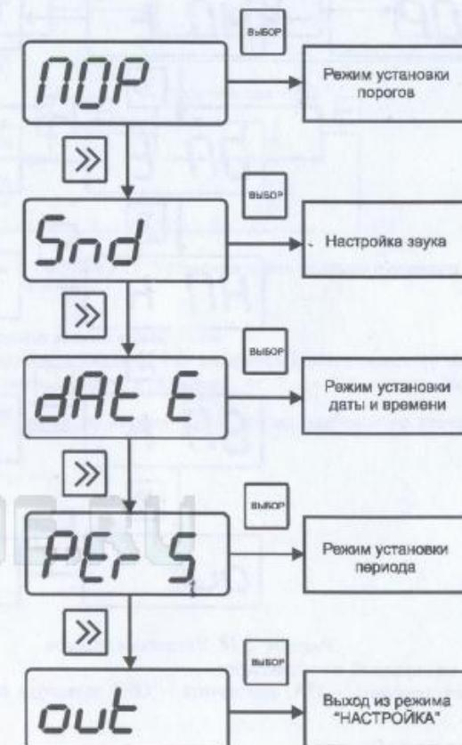
Рисунок 5.17 Схема режима НАСТРОЙКА ИВТМ-7 М 6
