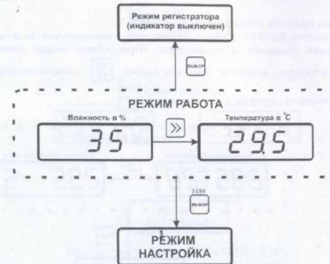
Рисунок 5.9 Режим РАБОТА ИВТМ-7 М С
