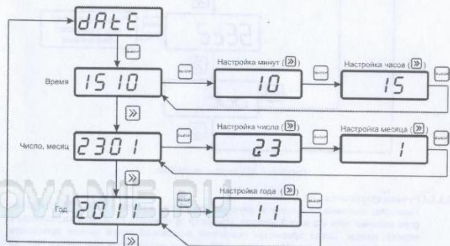
Рисунок 5.13 Установка часов реального времени
