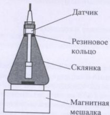
Рисунок 2.2 – Положение датчика в склянке при измерении БПК
