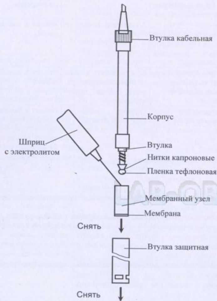
Рисунок 2.3 – Схема разборки датчика при заливке, замене электролита, при замене тефлоновой пленки и мембранного узла
