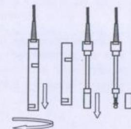
– погрузить датчик в дистиллированную воду на 2 ч, разместив его в сосуде так, чтобы не повредить тефлоновую пленку (можно навернуть защитную втулку);
