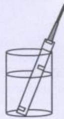
– промыть мембранный узел в дистиллированной воде и надеть его на втулку, не допуская натяжения мембранны;
