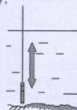
**Примечание** – Если температура датчика и контролируемой среды отличаются, то время установления показаний достигает 3-5 мин.
