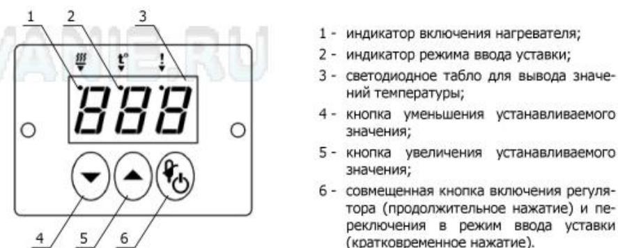
Рисунок 2 — Лицевая панель регулятора
